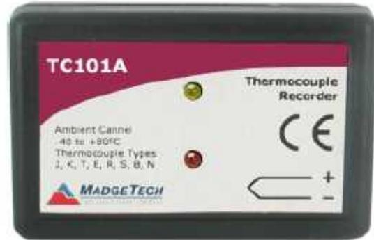
TC101A は小型ミニチュアサイズの電池で作動する温度データロガーです。温度は本体内部温度並びに各種熱電対センサの外部の 2 チャンネルです。使用できる熱電対センサは K, J, T, E, R, S, B, N タイプ全てに対応します。
